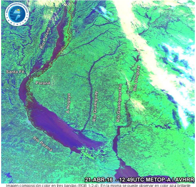
21-ABR-16 - 12:49UTC METOP-A / AVHRR Imagen composición color en tres bandas (RGB 1-2-4). En la misma se puede observar en color azul brillante los ríos, lagunas y áreas anegadas. Los tonos de azul menos intensos, corresponden a distintos niveles de humedad del suelo.
